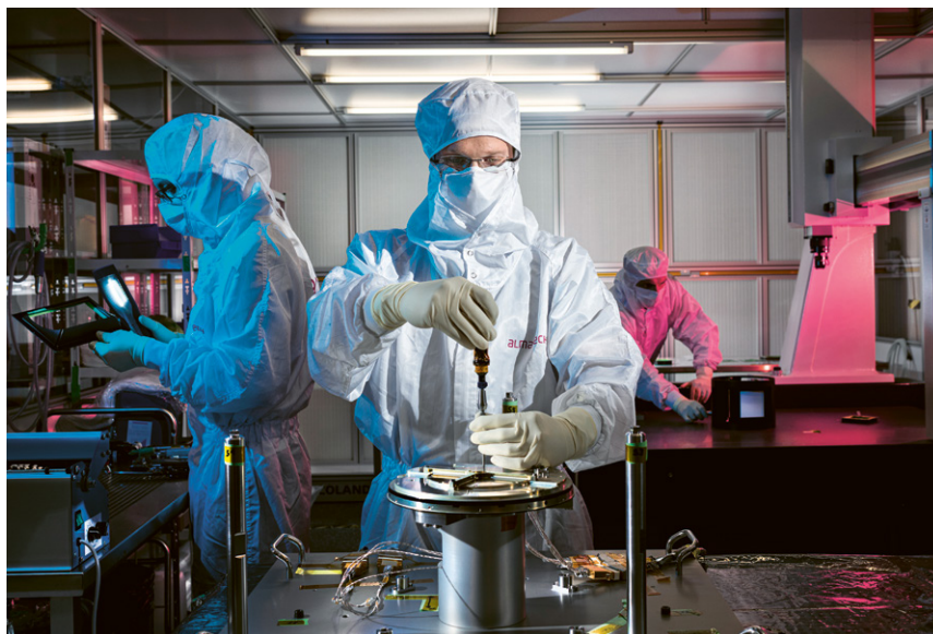
Almatech Cleanroom s'occupe de l'intégration et des essais des roues de réaction pour satellites.
