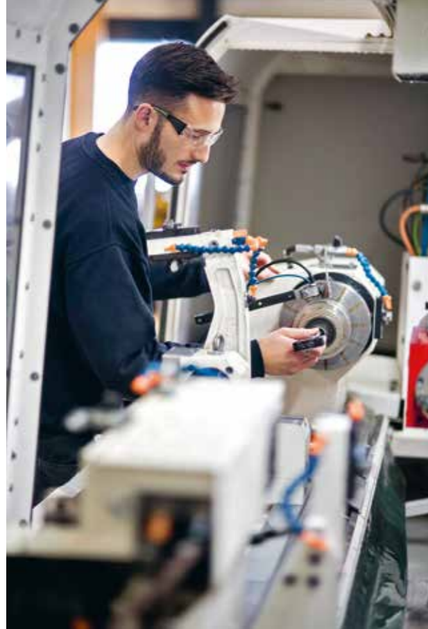
Ein Mitarbeiter von Sauter Bachmann beim Rundschleifen von Aviatikteilen.
