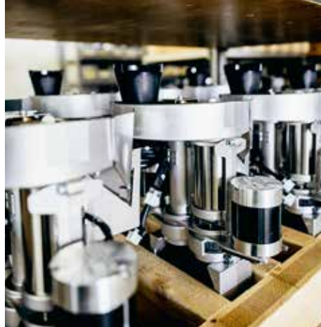
Bei Rex-Royal wird aufgrund der kleinen Serien vieles noch in Handarbeit gefertigt. Herzstück jeder Maschine ist die Brüh-einheit aus Edelstahl.
